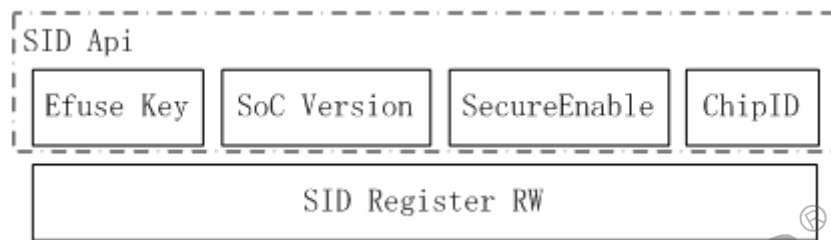
图 3-1: SID 驱动的内部结构
